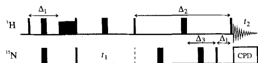
Abb. 25. Pulssequenz für ein J -moduliertes [^{15}N, ^1H] -COSY-Experiment zur Bestimmung der ^3J_{(H^N, H^\alpha)} -Kopplungskonstante in Peptiden. Die Pulssequenz korreliert ^{15}N -Kerne mit den direkt gebundenen Amidprotonen. \Delta_1 wird auf 1/(2^1J_{(N, H)}) gesetzt; \Delta_2 ist der variable Delay, in dem sich die H^N - H^\alpha -Kopplung entwickelt; \Delta_3 = \Delta_2 - \Delta_1 - 180^\circ(^{15}N) . Zur Bestimmung der Kopplungskonstante wird eine Serie von Spektren mit unterschiedlicher Länge des Delays \Delta_2 aufgenommen und die Kreuzsignalvolumina an Gleichung (7) rechnerisch angepaßt (siehe Abb. 26).
